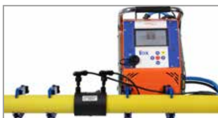
11. Inicio de la soldadura.
